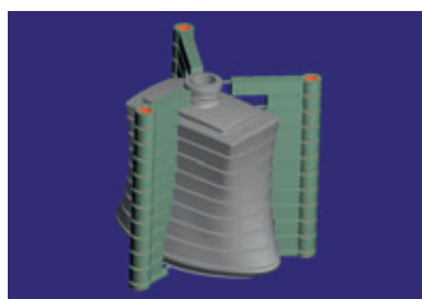
Assemblage par pontets
