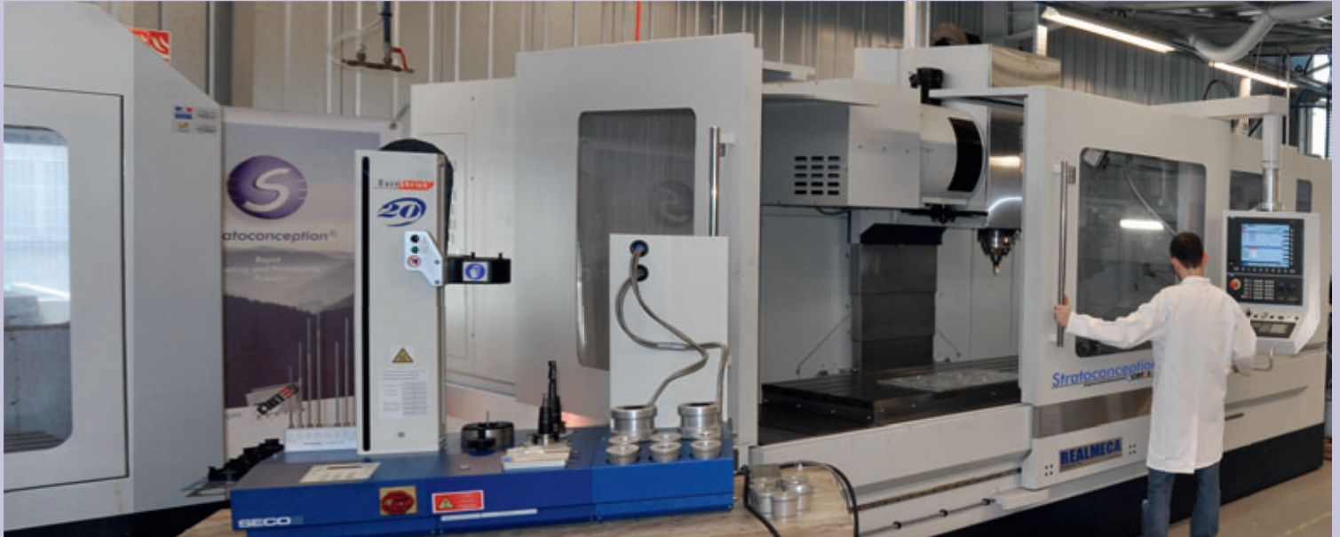
Exemple d'intégration du procédé de Stratoconception® sur machine SPINNER REALMECA
