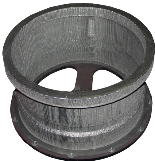
► Cylindre réalisé avec le procédé de fabrication additive CLAD (avec l'autorisation d'Irepa Laser, ESA and Amaze)
